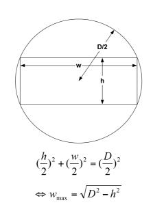
Fig. 15 : Robot Width
